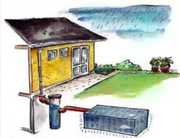
Opbygning af faskine af plastkassette ved parcelhus
